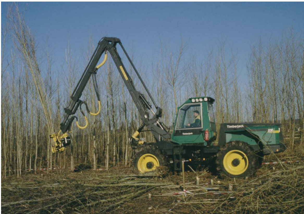
Abbildung 3: Der Fäller-Bündler bei der Ernte von fünfjährigen Pappeln
